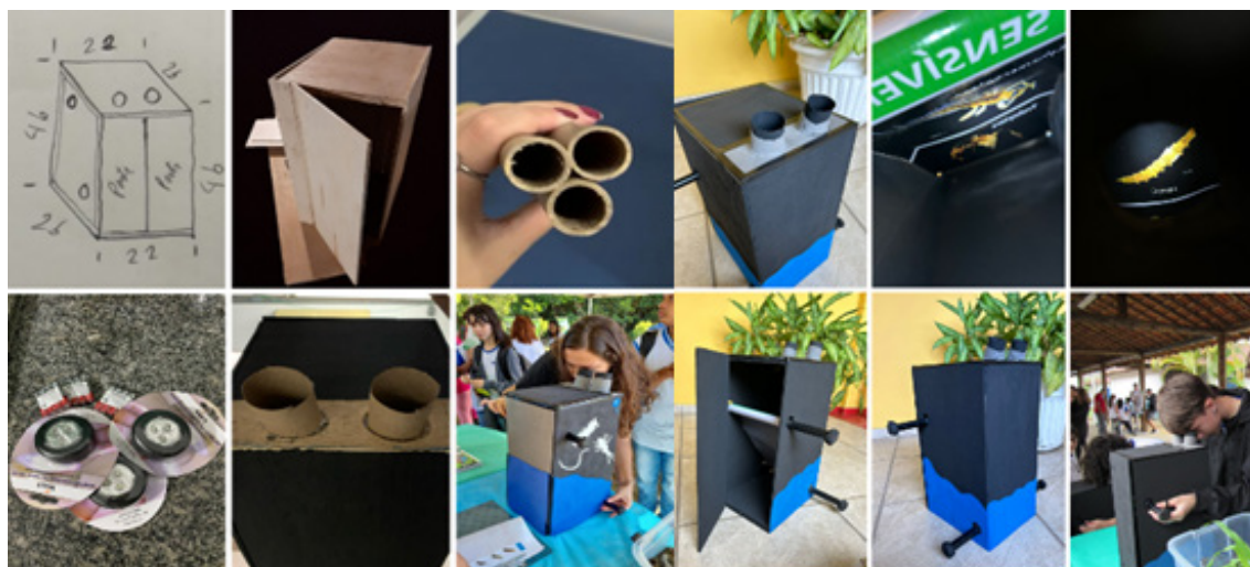
Figura 1: A imagem a seguir exemplifica a fase de concepção inicial do microscópio didático, evoluindo para sua construção em MDF, com destaque para os materiais empregados, pintura aplicada e o resultado final alcançado.
