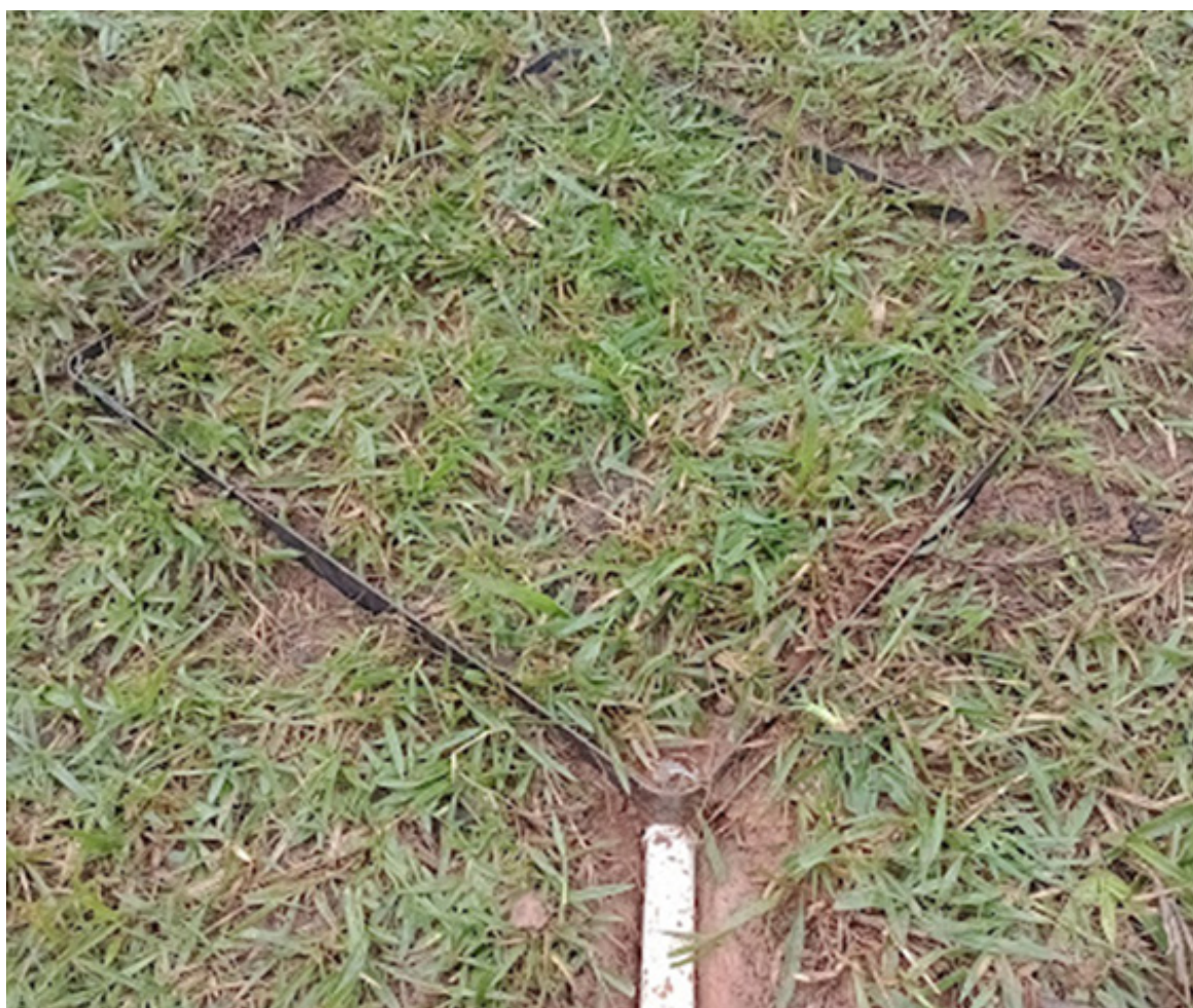
Figura 4: Barreira de contenção para coleta do escoamento superficial na PD.
