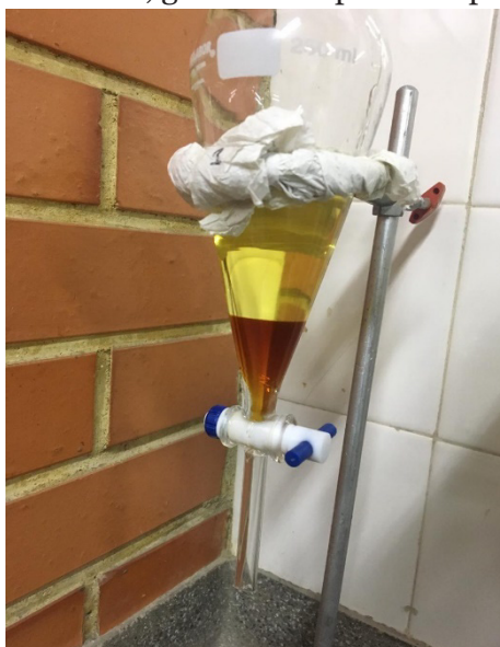
Figura 7. Etapa de separação do biodiesel, glicerol e impurezas após a reação de transesterificação.
