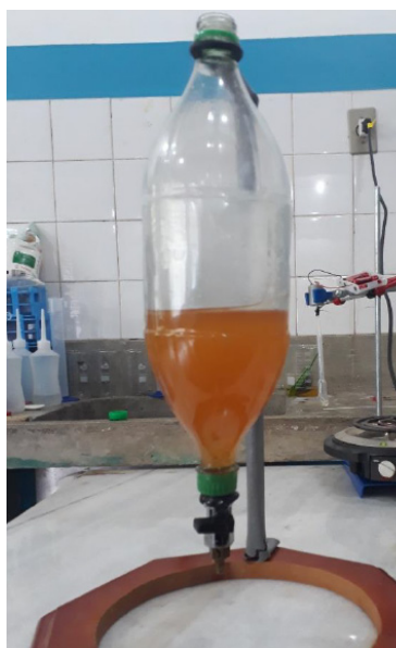
Imagem 4: Reaproveitamento de garrafa PET, pipeta de Pasteur e motor a pilha para a produção de biodiesel e sabão
