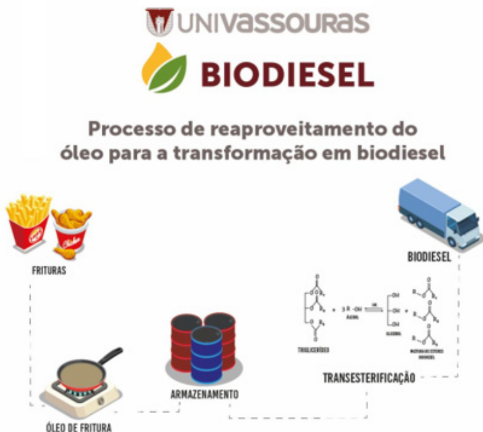
FIGURA 3. Ilustração do processo de síntese de biodiesel a partir da reação de transesterificação utilizada para capacitação dos alunos das escolas do Município de Vassouras.
