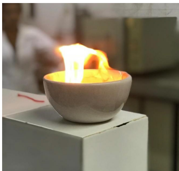
Figura 3. Teste de chamas para verificação de formação de biodiesel a partir da reação de transesterificação.
